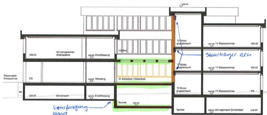
Abbildung 5: Querschnitt durch ehemaligen Lichthof
