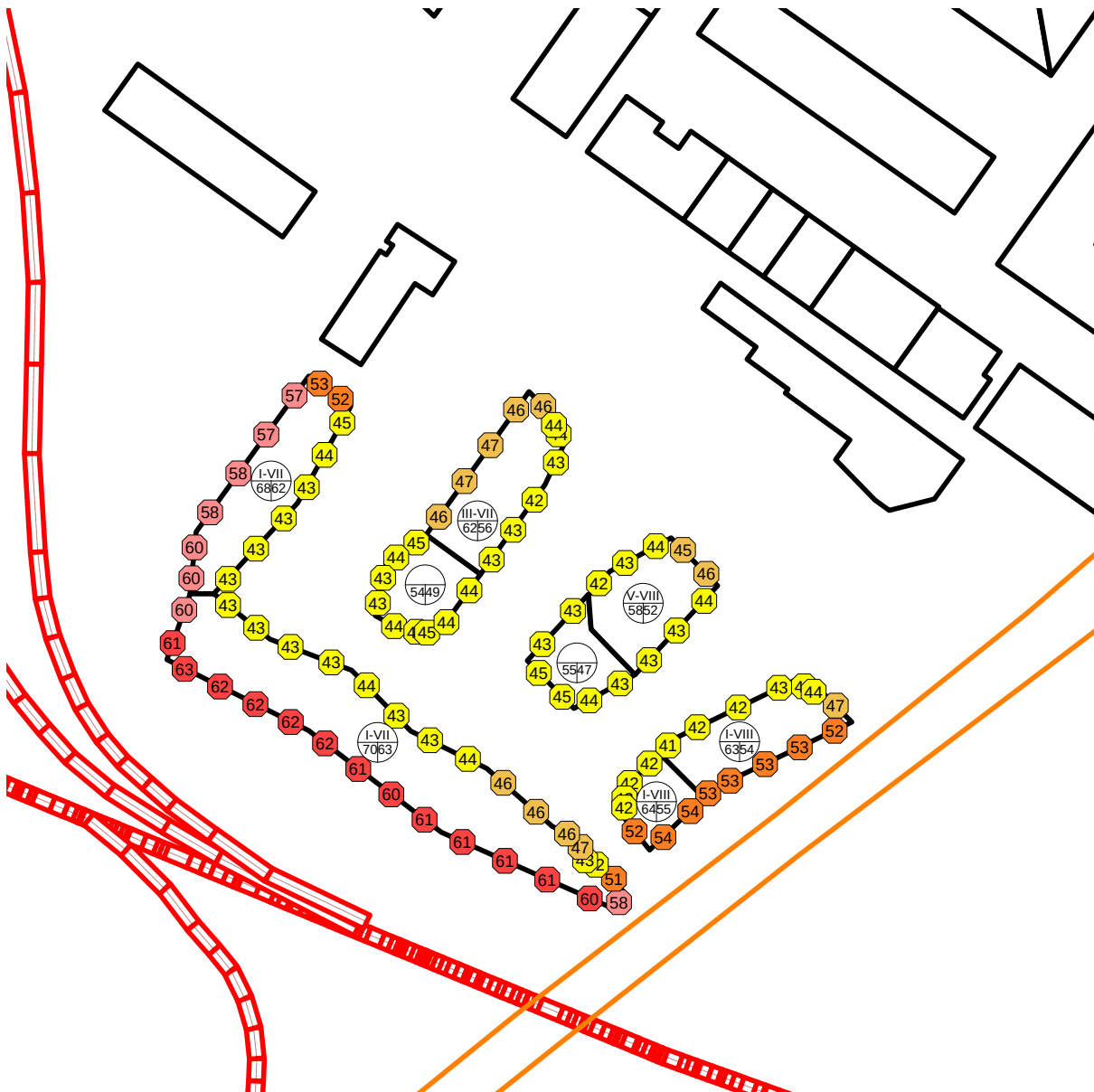
Abbildung 4: Lärm Strasse (Nacht), Erdgeschoss
