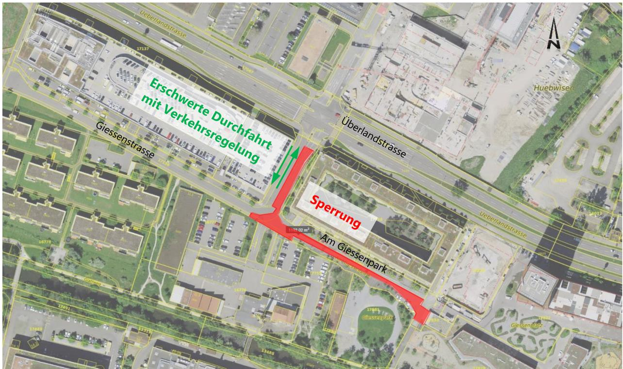
Abb. 1: Fläche Deckbelageinbau in Rot, Hintergrund Orthophoto mit amtlicher Vermessung.
