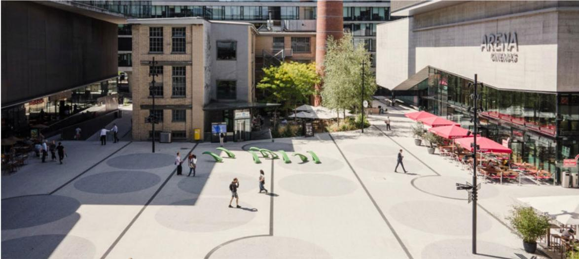
Abb. 16: Beispiel heller Gussasphaltbelag (Quelle: Gussasphaltmagazin, Freiflächen Sihlcity, Silvano Pedrett, sivanopedrett.com)
