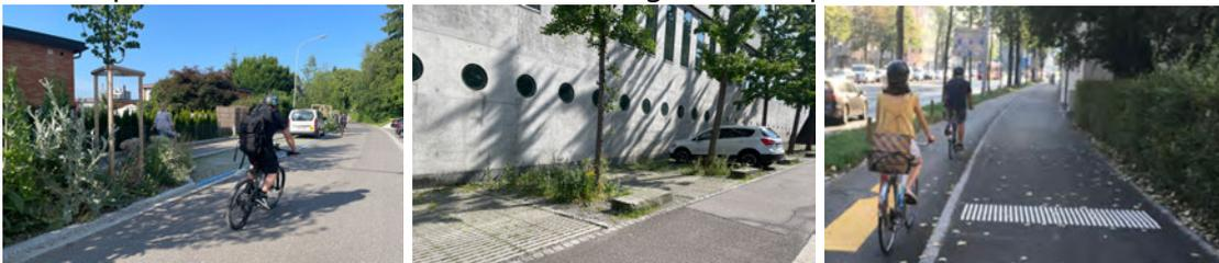
Abb. 5: Vegetation, Baumpflanzung, Rasenliner / getrennte Flächen, separate Führung Fuss-/Veloverkehr (Fotos Rasenliner, asa AG /Foto getrennte Flächen, TBA Kanton BE)
