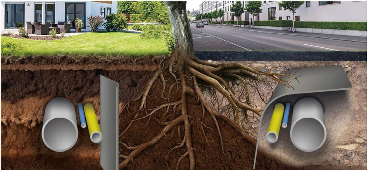
Abb. 17: Schemabild zu Wurzelschutzmatte (Quelle: SYTEC GEOPRODUCTS, Sytec Rootfix, [www.sytec.ch](http://www.sytec.ch))
