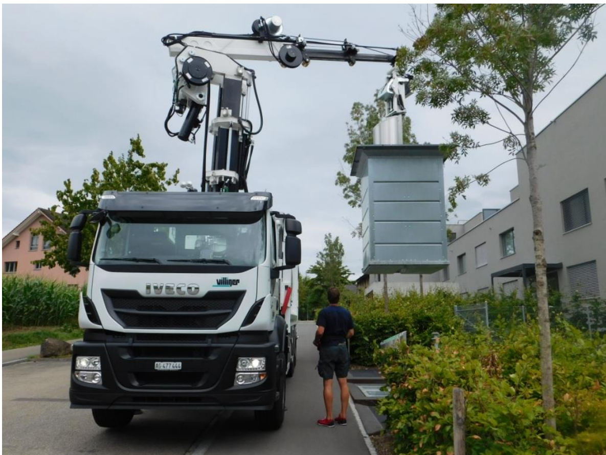
Unterflurcontainer bei der Entleerung
