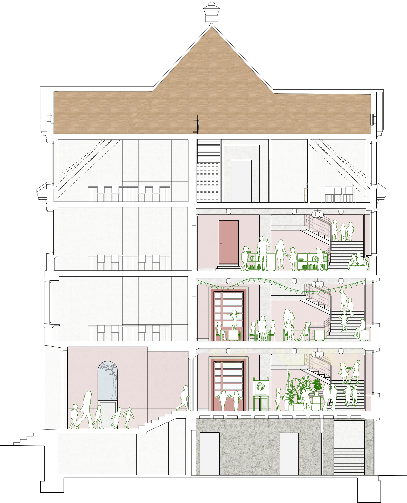
Querschnitt durch Hallenraum Haus B 1:100
