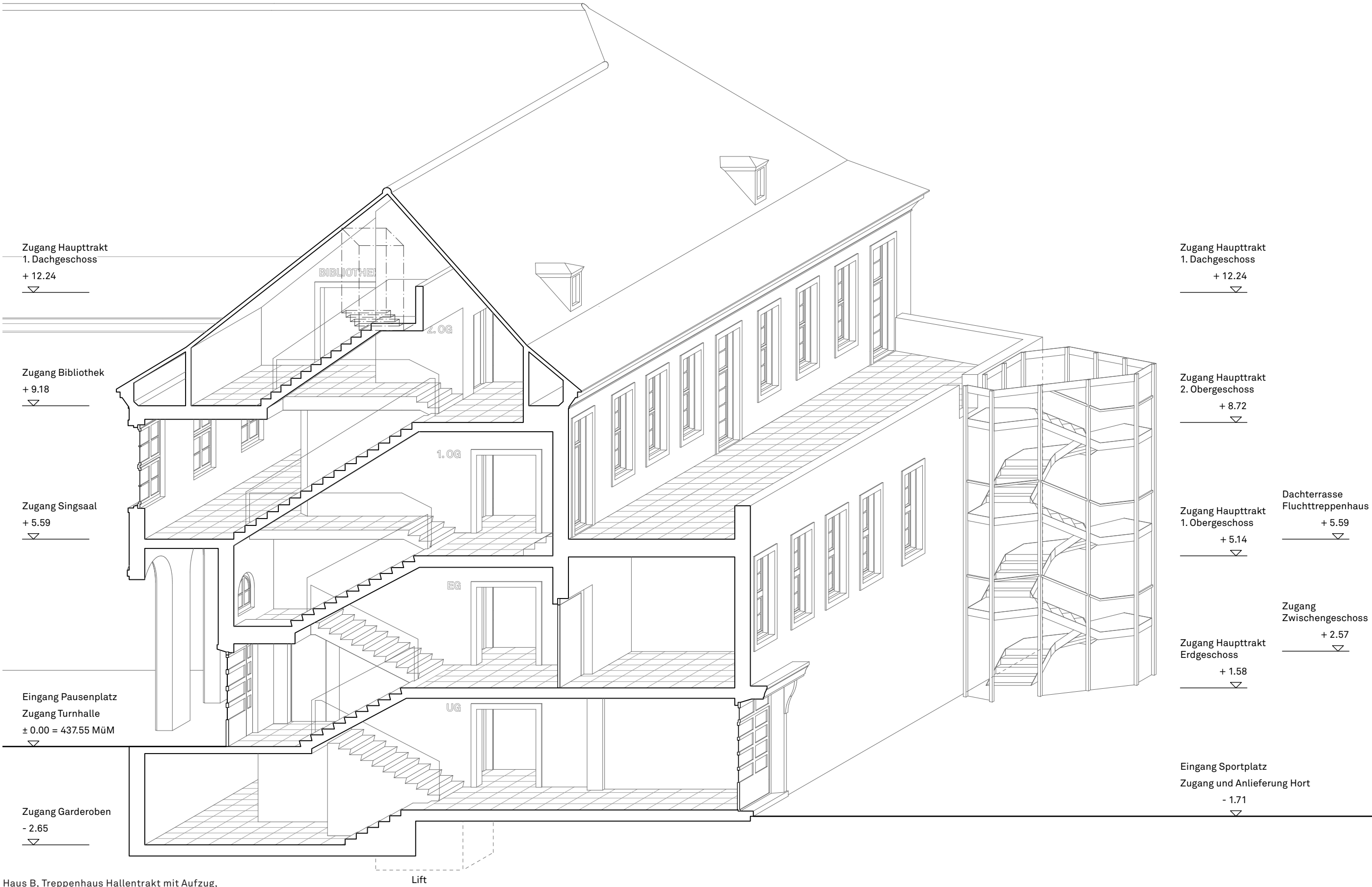
Haus B, Treppenhaus Hallentrakt mit Aufzug, Schnittaxonometrie 1:100
