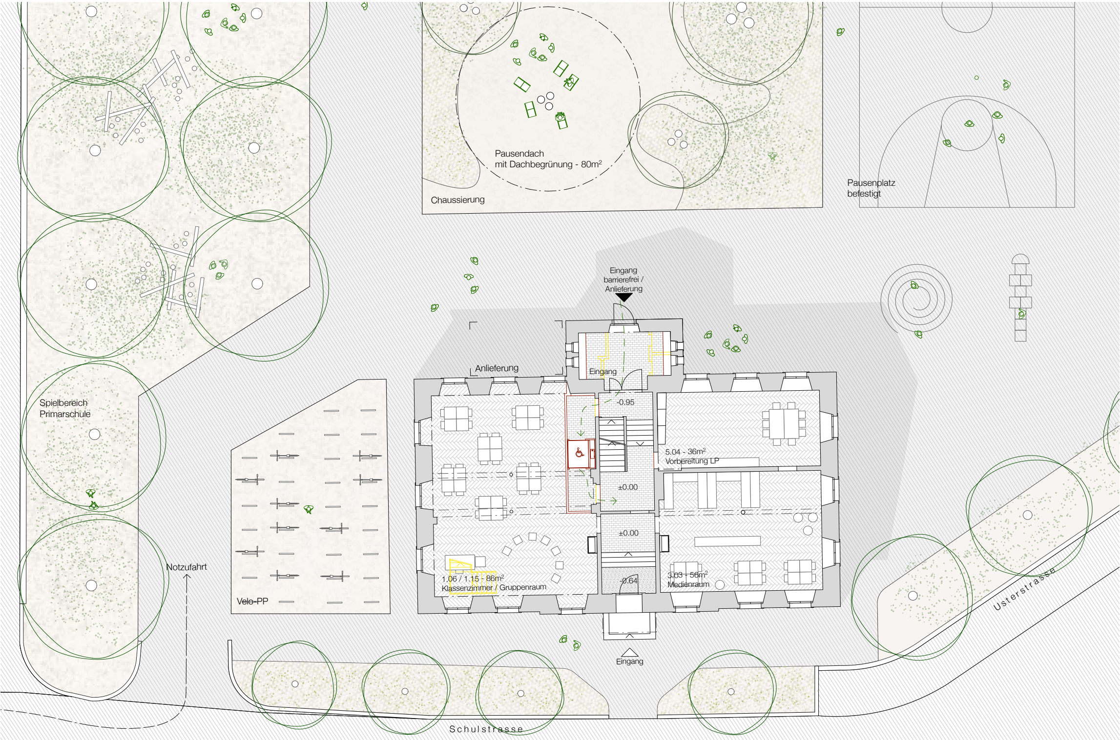
Grundrisse Erdgeschoss Schulhaus A und B 1:200
